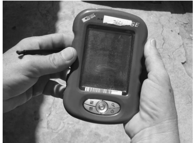
Figura 8 - O dispositivo da PNAD Contínua sob a incidência da luz solar: legibilidade prejudicada.
